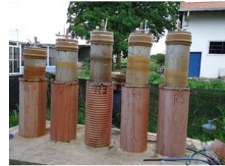
Fig.4 - Biodigestores p/coleta de gases
