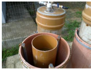
Fig.2ª - Conj.selo d'água, fermentador(b) e gasômetro
