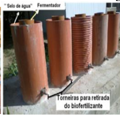
Fig.2ª - Conj.selo d'água, fermentador(b) e gasômetro
