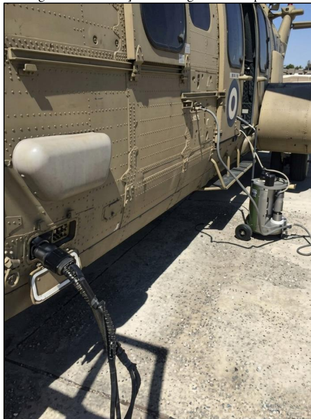
Figura 21: Realização da lavagem no compressor
