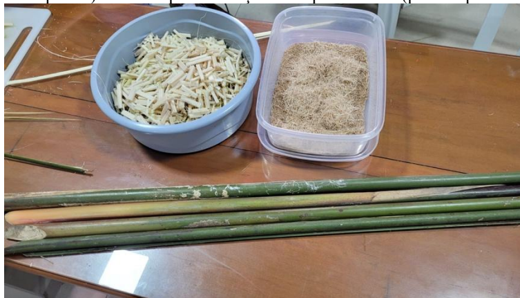
Figura 01 - Caules de arumã (parte inferior), fibras internas cortadas em segmentos de aproximadamente 3 cm (parte superior esquerda) e fibras após trituração no liquidificador (parte superior direita).
