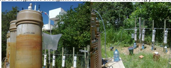
Fig.5 - Coleta de biogás nos biodigestores e nos filtros com bolsa Bag para análises
